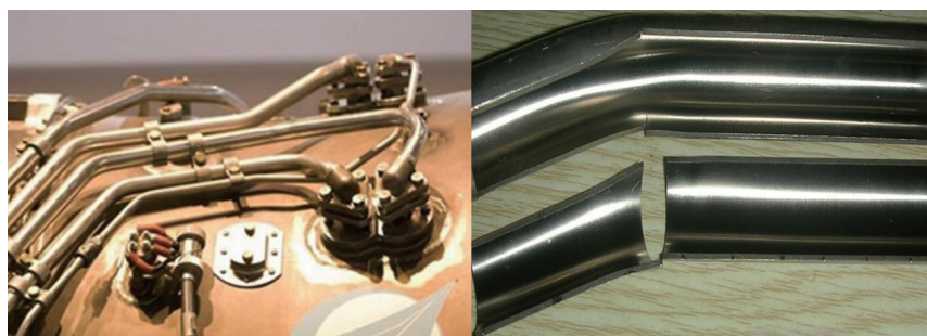
弯管内表面研磨效果图
